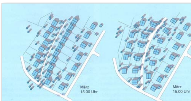
Abb. 24: Verschattung bei unterschiedlicher Gebäudestellung
