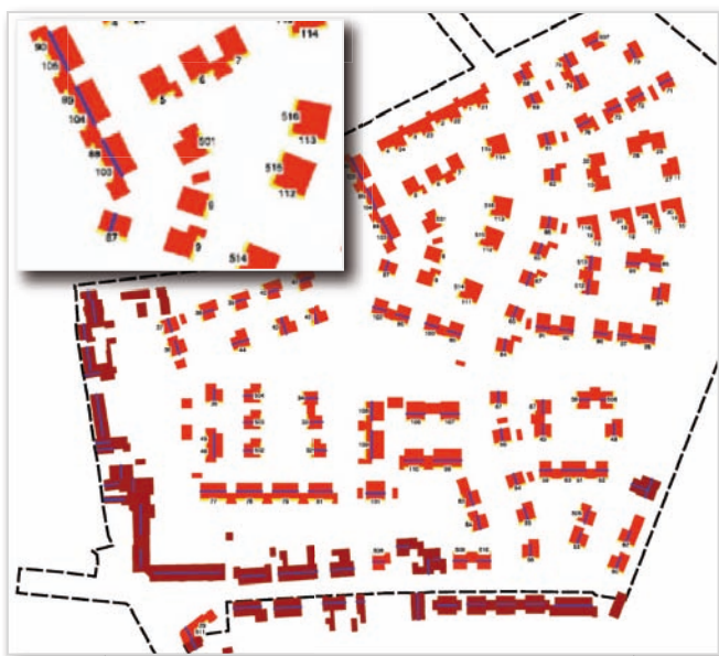
Abb. 7: Grundlage der solarenergetischen Berechnung - Energiegewinnfassaden (gelb)
