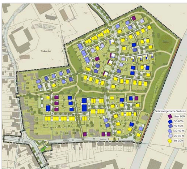
Abb. 9: Solarenergetische Verluste vor Optimierung (SF1)
