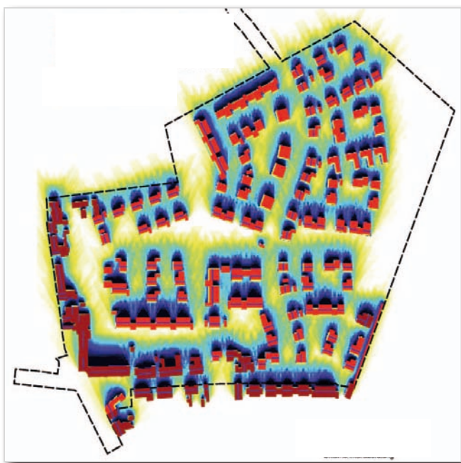
Abb. 11: Ergebnis der Solarenergetischen Simulation
