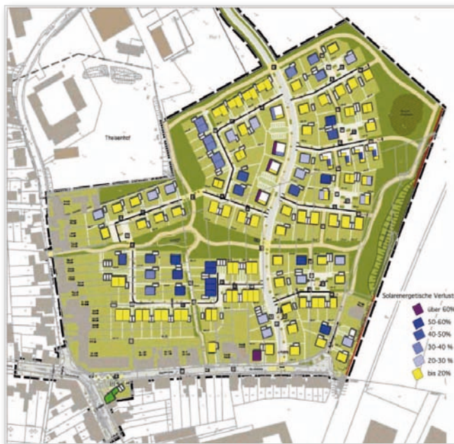
Abb. 12: Solarenergetische Verluste nach Optimierung (SF 1)
