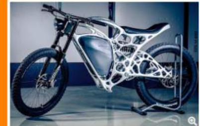
Das Motorrad wiegt insgesamt nur 35 kg und wird von einem 64W Elektromotor angetrieben. Quelle: AP/Anadolu
