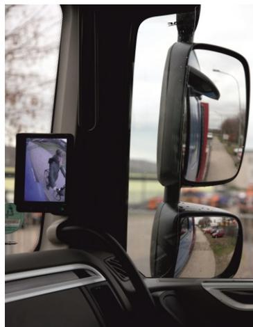
In den LKW-Außenspiegeln ist die Radfahlerin nicht zu sehen. Die Kameramonitore hingegen zeigen sie deutlich (Quelle: JR WERBUNG ETC.)
